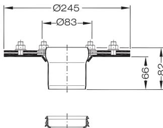
**Aufsatzelement mit Muffe**
